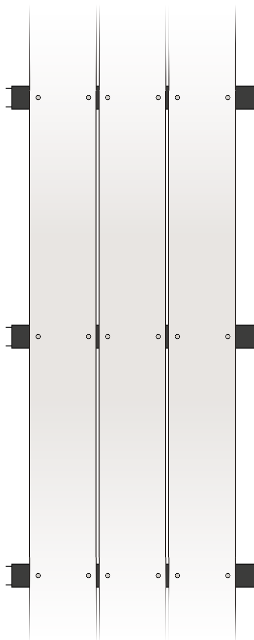
Podwójne mocowanie z wykorzystaniem wkrętów Cedral o dopasowanych kolorach lub gwoździ żebranych ze stali nierdzewnej
