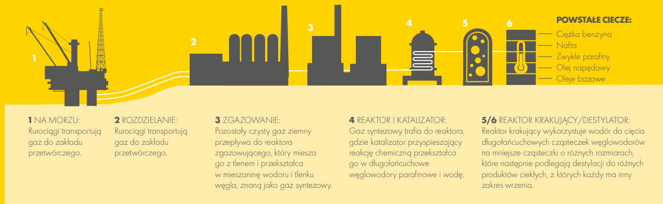
Rysunek 2: Proces GTL przekształca czysty gaz ziemny w czyste paliwa i wysokiej jakości oleje bazowe.
